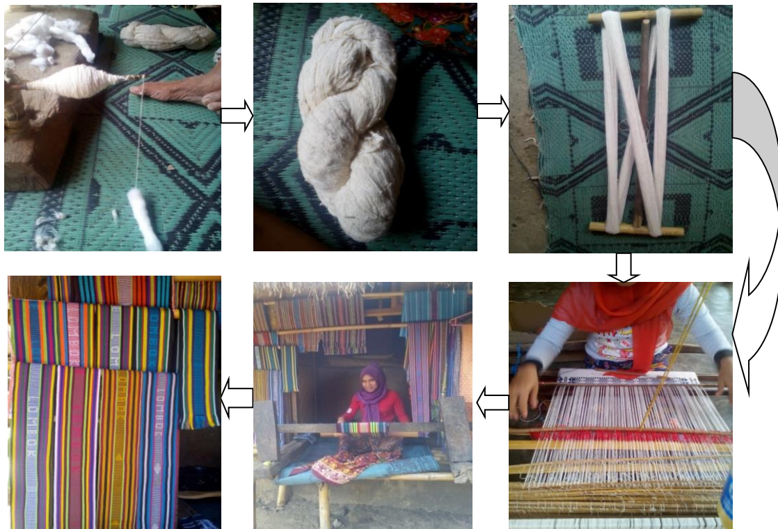
Gamabar 2 : Proses pengolahan benang dari kapas sampai menjadi tenun sasak
